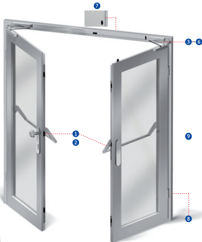
Beispiel einer zweiflügeligen Paniktür nach EN 14351-1
